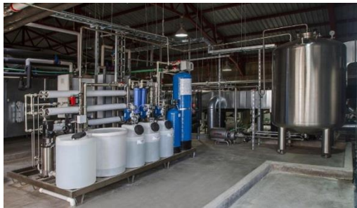
Figura 2 Sistema Osmosis Inversa
