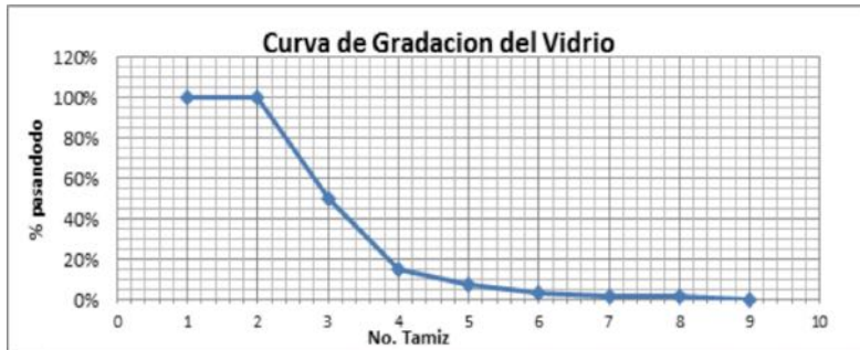
Figure 3 - Granulometría del Vidrio Triturado
