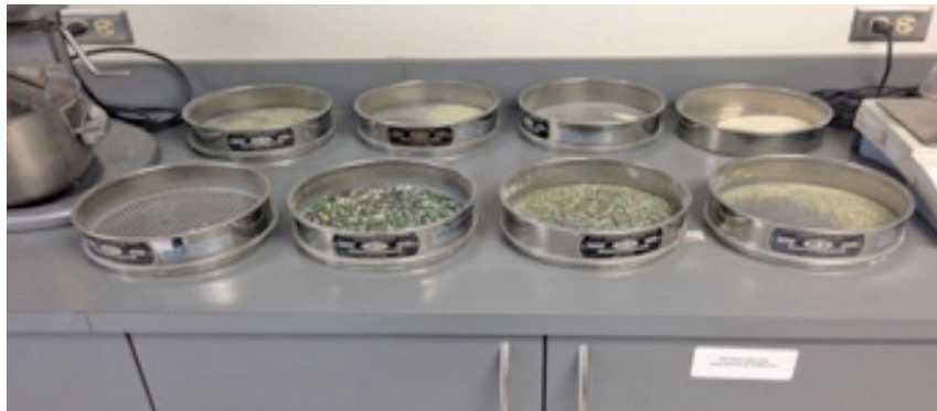
Figure 2 - Material Retenido en los Tamices
