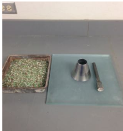
Figure 5- Prueba Absorción del Vidrio
