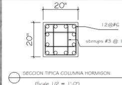
Detalle de Columna Típica de Hormigón
