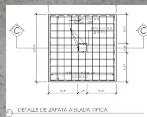
Sección Zapata Aislada
