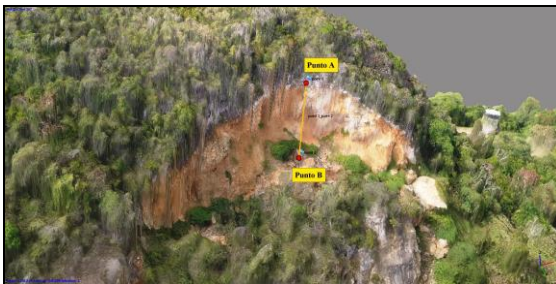
Figura 11 Medición del Desplazamiento Vertical, utilizando Agisoft Photoscan. (Fuente: A. Morales, 2015)
