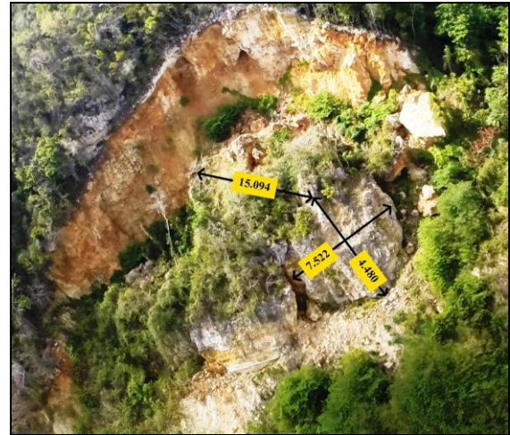
Figura 12 Medidas Específicas del Bloque en el Áreas de Riesgo. (Fuente: A. Morales, 2015)
