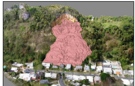
Figura 13 Modelo 3D y Representación de Área de Volumen Calculado, Agisoft Photoscan. (Fuente: A. Morales, 2015)
