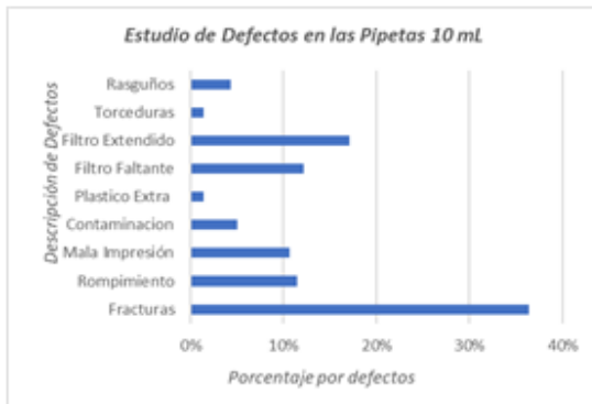
Figura 4 Estudio de Defectos 2do Lote
