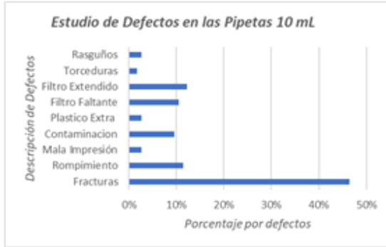
Figura 3 Estudio de Defectos 1er Lote
