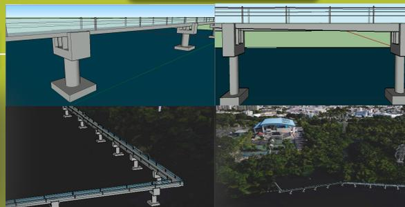
El puente luego de ser rehabilitado, será expandido de ocho pies de ancho a catorce pies de ancho. Esto sería realizado con el método de voladizo, con una expansión de tres pies para cada lado.
