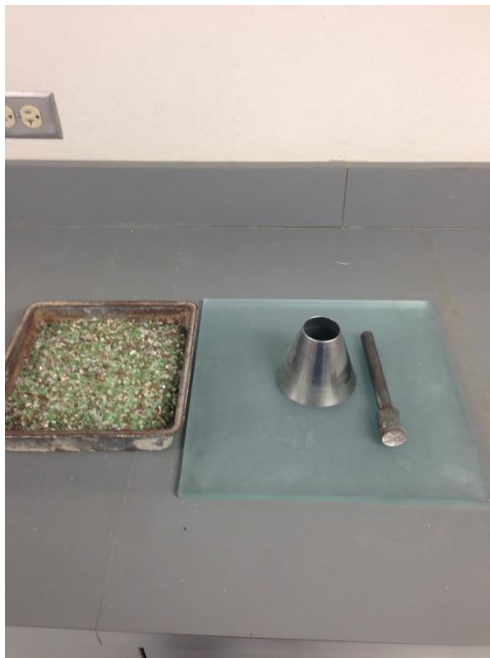
Figura 5 Prueba Absorción del Vidrio
