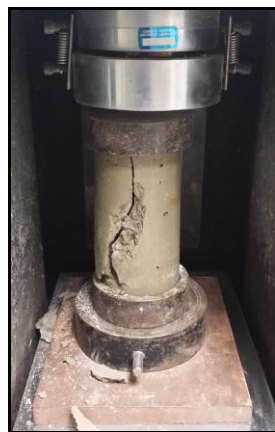
Figura 5 Fallas en Prueba de Compresión Mezcla Experimental
