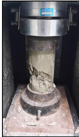
Figura 4 Fallas en Prueba de Compresión Mezcla Control
