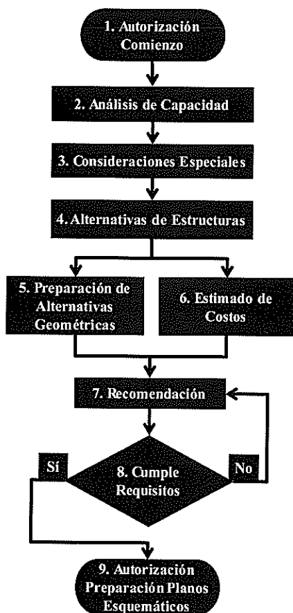
FIGURA 3 DIAGRAMA DE FLUJO DE ETAPA DE DISEÑO CONCEPTUAL
