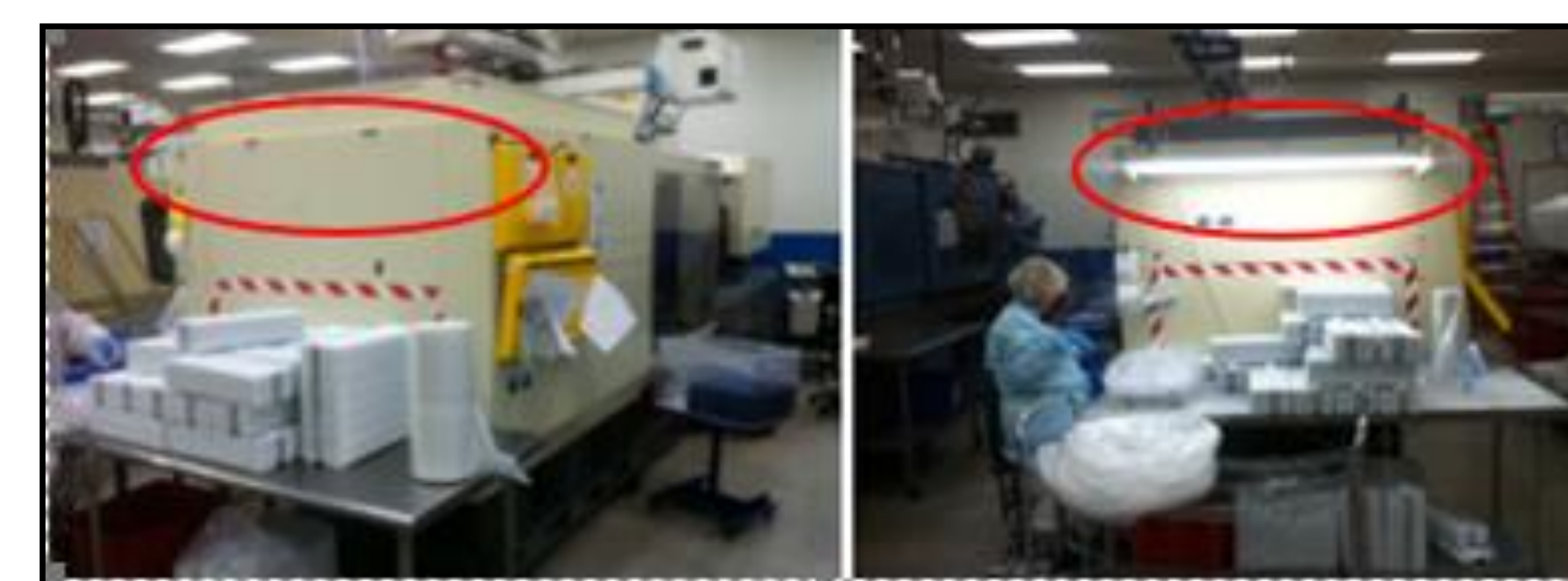
Figura 11 Lámpara en área de inspección
