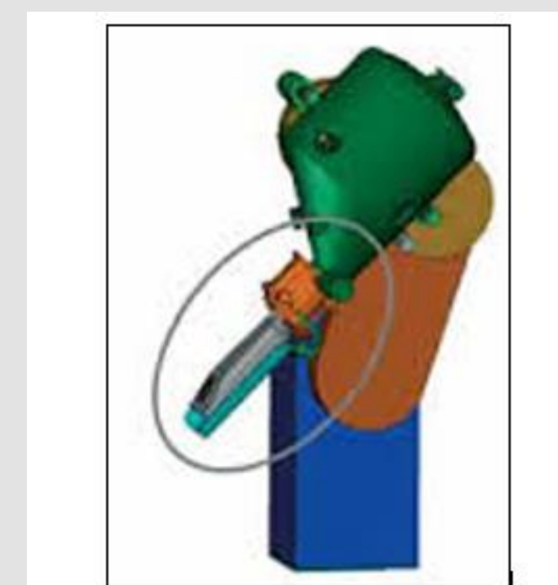
Figura 3 Tanque de tapones de goma, conectado al puerto alfa beta
