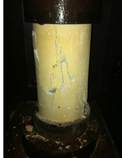
Figura 6 Falla en Compresión Tipo II en la Muestra de 900 °F de Roca Silícea
