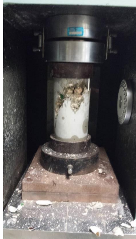
Figura 3 Falla en Compresión Tipo [IV] en los 28 Días
