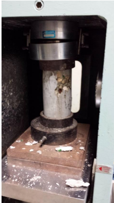
Figura 4 Falla en Compresión Tipo [IV] para Muestra desde 900 °F con Vidrio
