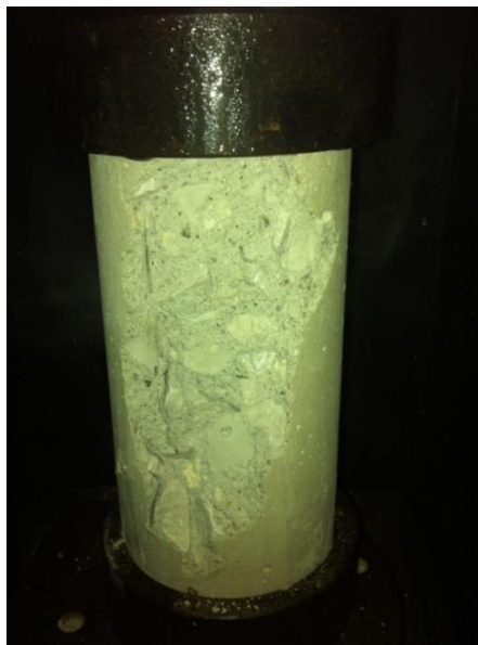
Figura 5 Falla en Compresión Tipo I en la Muestra de 900 °F de Caliza
