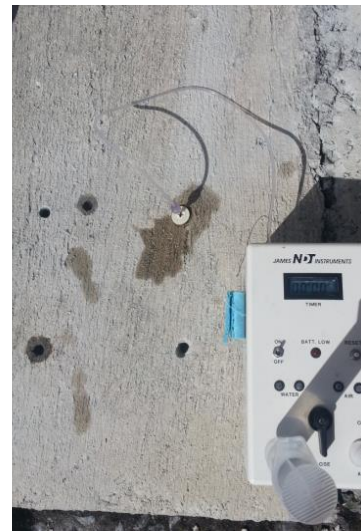
Figura 10 Prueba de permeabilidad - Mezcla #2
