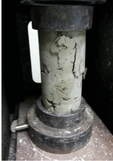
Figura 7 Ruptura de cilindro en prueba de compresión
