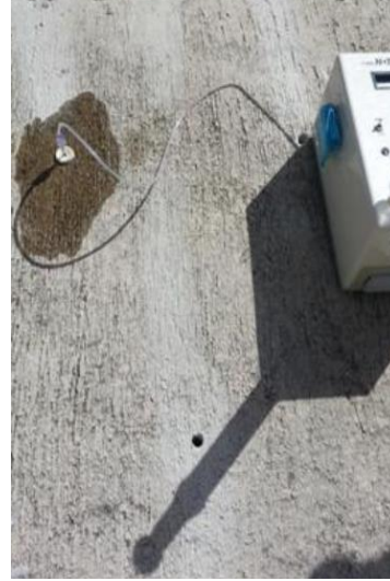
Figura 9 Prueba de permeabilidad - Mezcla #1
