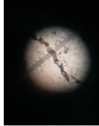
Figura 13 Medición de grietas - Mezcla #2
