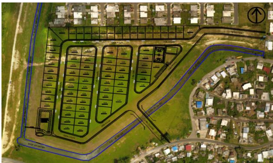
Figura 11 Distribución de los solares propuestos, diseño geométrico de carreteras y localización de puente propuesto
