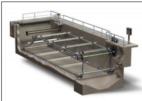
Figura 4 (Water Online) Sistema de remoción “scraper”
