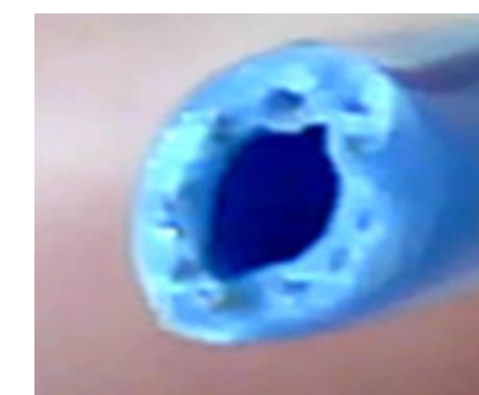
Figura 6 Ilustración de un "Shaft" o "Cuerpo del Catéter" Deformado por el uso de un Cortador o Pinza Manual.
