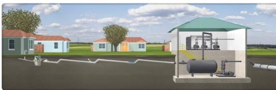
Figura 4 Ejemplo de Sistema Sanitario por Vacío
